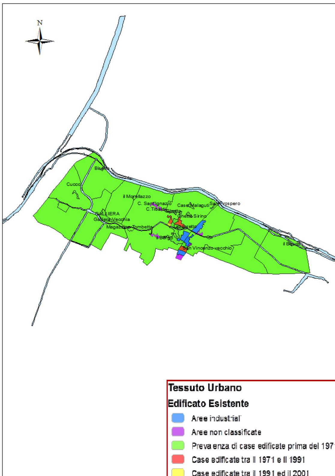
*Figura 5: Particolare delle sezioni censuarie di riferimento e anno di costruzione medio degli edifici; fonte ISTAT 2001 (Dati elaborati su fonte ISTAT 2001)*
